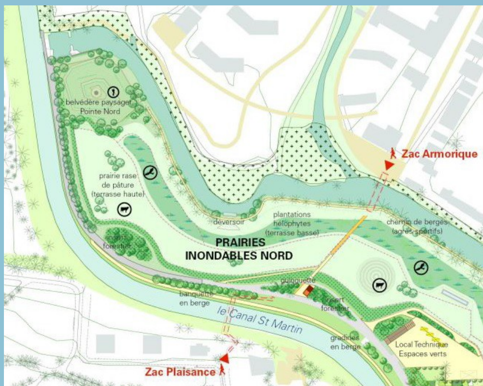
Illustration 34 : plan de situation de la zone d'expansion de crue située au nord des Prairies Saint-Martin (Rennes, 2015)
